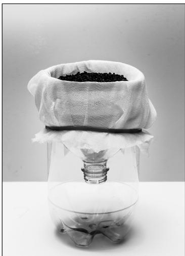
2. Vierte una muestra de agua sucia en la boca de la base filtradora.
